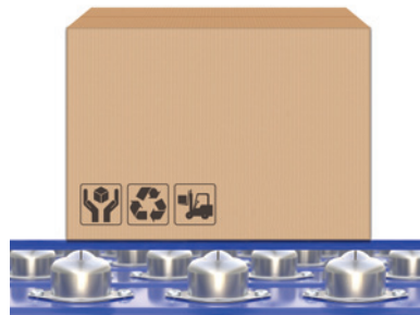
Sistema MOVE® não acionado, as esferas ficam abaixo da placa superior.
