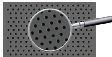
Sistema MOVE® não acionado, as esferas ficam abaixo da placa superior.
